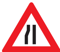
Drum îngustat pe partea stânga
